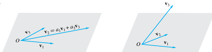
(a) Vectores en R^3 , linealmente dependientes (b) Vectores en R^3 , linealmente independientes
